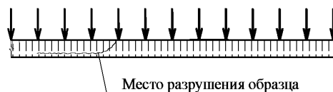
Рисунок Б.7 – Типичная схема разрушения сердцевины от сдвига
