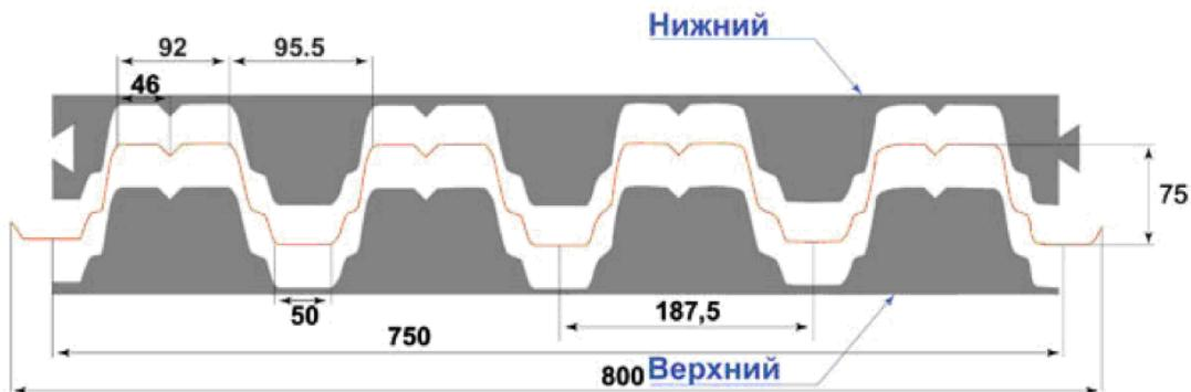
Уплотнитель для профилированного листа H 75 (полная ширина 800 мм; рабочая 750 мм).
