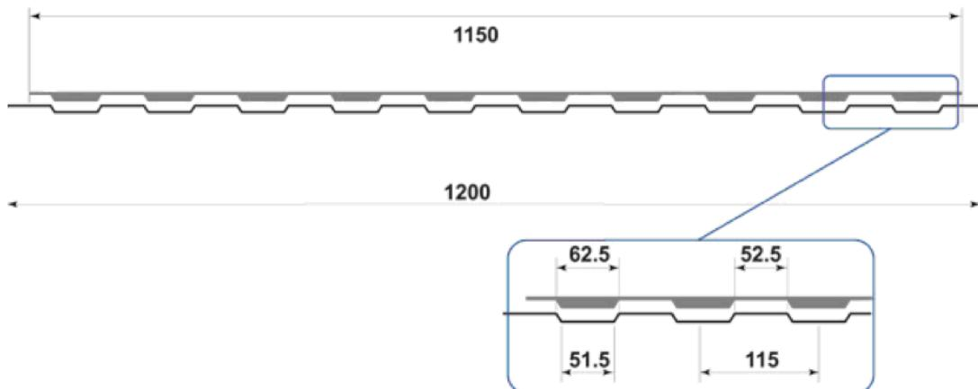
Уплотнитель для профилированного листа С-8 (полная ширина 1200 мм; рабочая 1150 мм).
