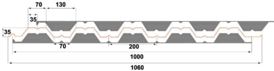
Уплотнитель для профилированного листа НС-35 (полная ширина 1060 мм; рабочая 1000 мм). Отсутствует деление на ВЕРХНИЙ и НИЖНИЙ (симметричный). Применяется в узлах стыков кровельных элементов (конек, примыкание), а так же при использовании НС-35 в фасадных системах в поперечных стыках.
