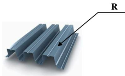
Маркировка профнастила **R** подразумевает присутствие капиллярной канавки, предотвращающей затекание воды под кровлю в месте соединения листов.
