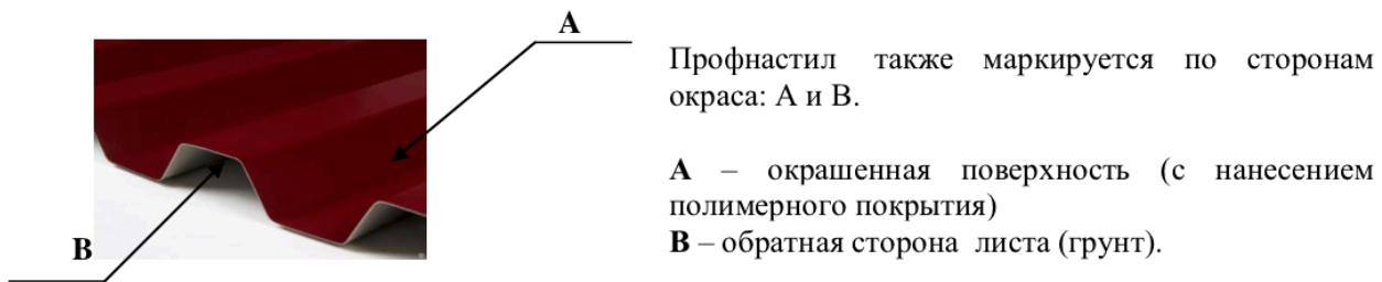
При выборе уплотнителя нужно понимать какой именно стороне профилированного листа он должен соответствовать. К какой стороне листа уплотнитель будет примыкать при монтаже и соответственно повторять ее контур.
