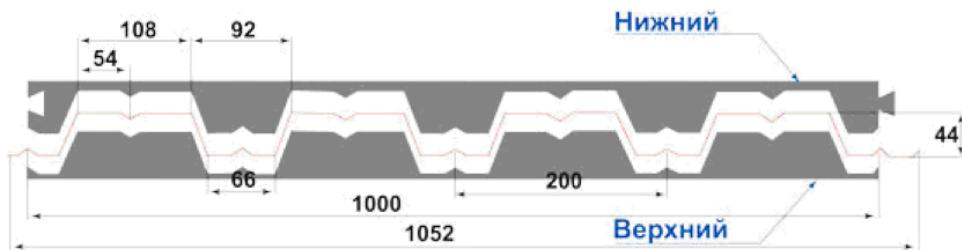
Уплотнитель для профилированного листа НС-44 ТУ 1000 ММК (полная ширина 1052 мм; рабочая 1000 мм).
