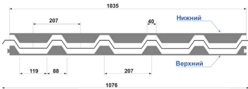
Уплотнитель для профилированного листа МП-35 (полная ширина 1076 мм; рабочая 1035 мм). Существует деление на ВЕРХНИЙ и НИЖНИЙ (асимметричный). Применяется в узлах стыков кровельных элементов (конек, примыкание), а так же в фасадных системах в узлах поперечных стыков.
