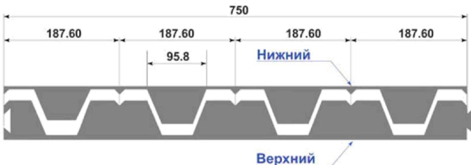
Уплотнитель для профилированного листа Н 57 (полная ширина 802 мм; рабочая 750 мм).
