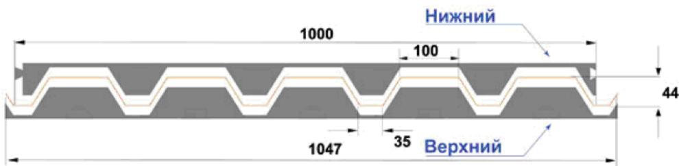
Уплотнитель для профилированного листа НС-44 и С-44 ГОСТ (полная ширина 1047 мм; рабочая 1000 мм).
