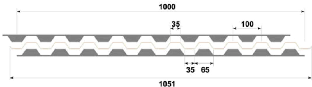
Уплотнитель для профилированного листа HC/C 21 (полная ширина 1051 мм; рабочая 1000 мм).
