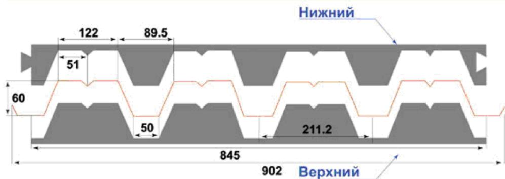
Уплотнитель для профилированного листа Н 60 (полная ширина 902 мм; рабочая 845 мм).
