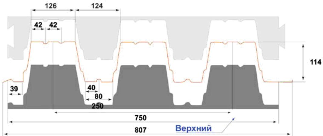
Уплотнитель для профилированного листа Н 114 (полная ширина 807 мм; рабочая 750 мм).
