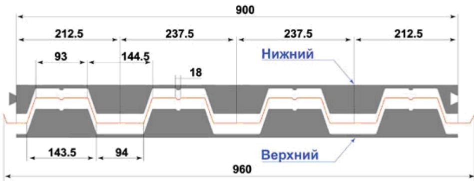
Уплотнитель для профилированного листа Н 57 (полная ширина 960 мм; рабочая 900 мм).
