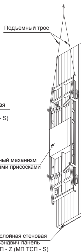
Схема строповки при вертикальной раскладке сэндвич-панелей
