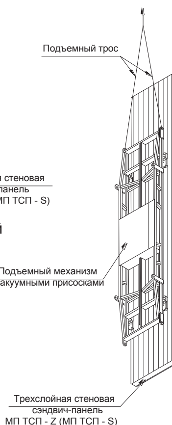
Схема строповки при вертикальной раскладке сэндвич-панелей
